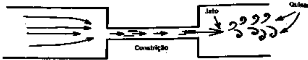
Figura 7: Modelo de produção de ruído turbulento para fricativas.
